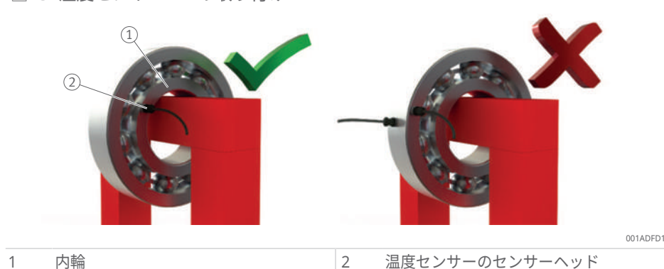
図 43 温度センサー T1 の取り付け
