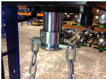
Abb. 26 Hebekettenbrücke am Kolbenboden
