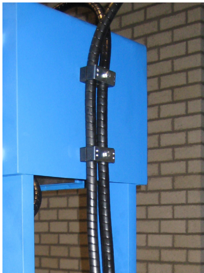
Abb. 11 Befestigung mit Schlauchschellen
