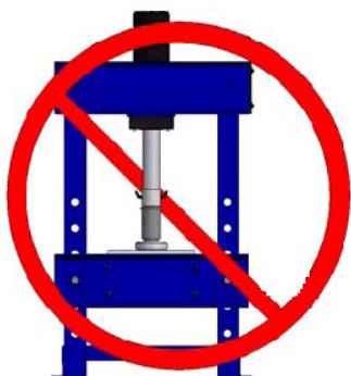
Abb. 5 Max. Kraft bei langem Hub
