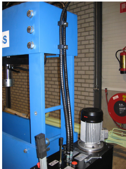
Abb. 11 Befestigung mit Schlauchschellen
