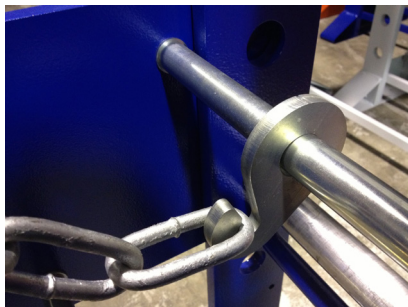
Afb. 26 Gebruik van de hijsketting bij de zuigerbodem (links) en tafelassen (rechts)
