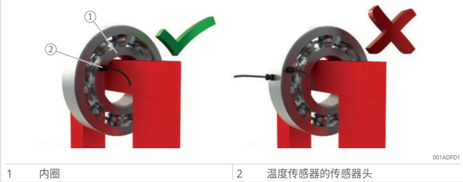
图 43 连接温度传感器 T1
