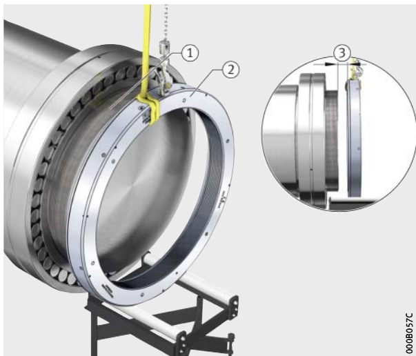
Fig. 17 Hydraulische moer neerleggen
