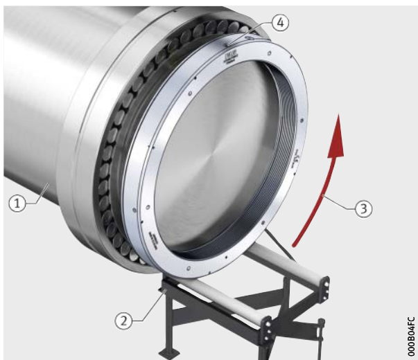
Figura 35 Desenroscado de la tuerca hidráulica
