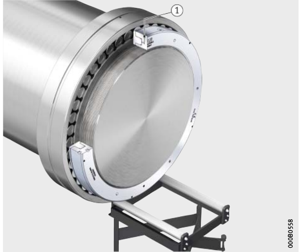
Figura 21 Afloje ligero de la tuerca hidráulica
