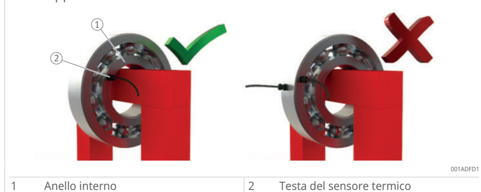
43 Applicazione del sensore termico T1
